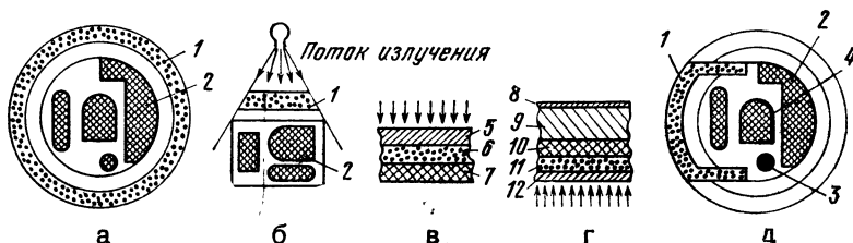
Рис. 2.5. Защита РЭА от ИИ общим (а); теневым (б) и многослойным экраном (в) и поглощающей прослойкой (г); схема гамма-нейтронной защиты (д)
